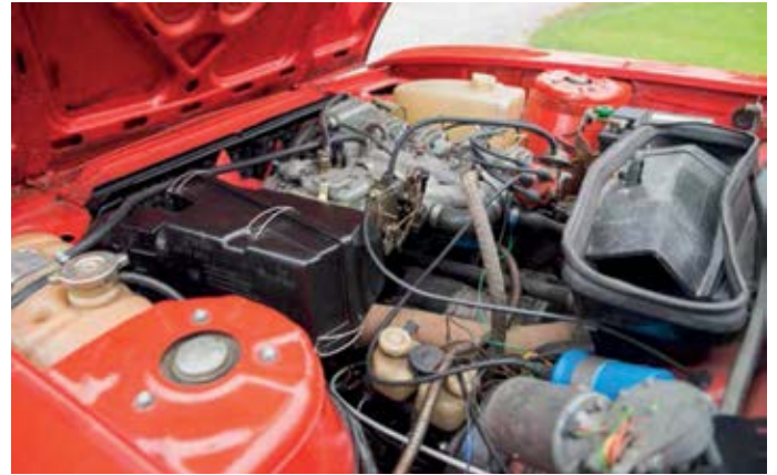
Oben: Während einer Fahrt von Sälen nach Funäsdalen bei minus 35 Grad fror der Kanal zur Kurbelgehäuseentlüftung ein. „Wahrscheinlich der Grund, warum der Motor umfassend überholt werden musste“, sagt Mats.
